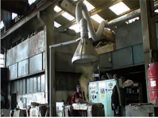
Fotoğraf: İç Ortam emisyonlarının toplanıp filtreden geçirilmesi
